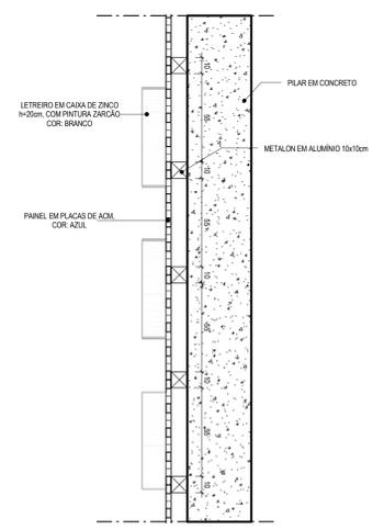
**4** DETALHE FIXAÇÃO DAS PLACAS
