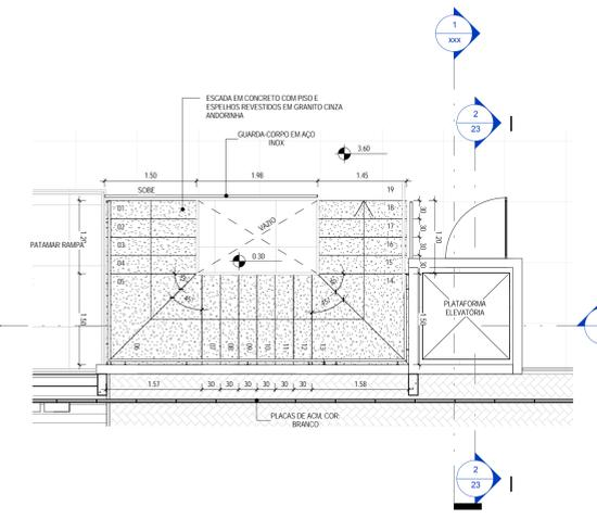
1 DETALHE ESCADARIA METÁLICA E PLATAFORMA ELEVATÓRIA
