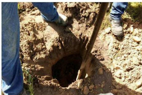
Foto 1 – Detalhe do estudo de subleito através da execução de sondagens a pá e picareta com coleta de amostras para execução de Ensaios de Laboratório.
