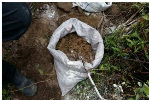
Foto 2 – Detalhe das amostras coletadas para execução de Ensaios de Laboratório.
